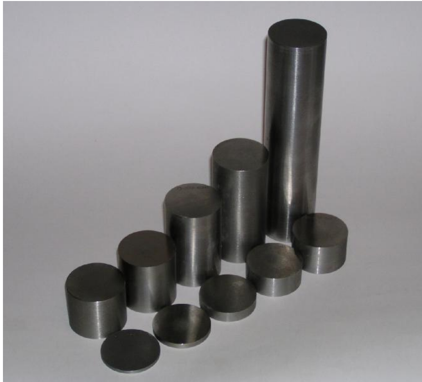
Рис. 1. Комплект мер эквивалентной ультразвуковой толщины
