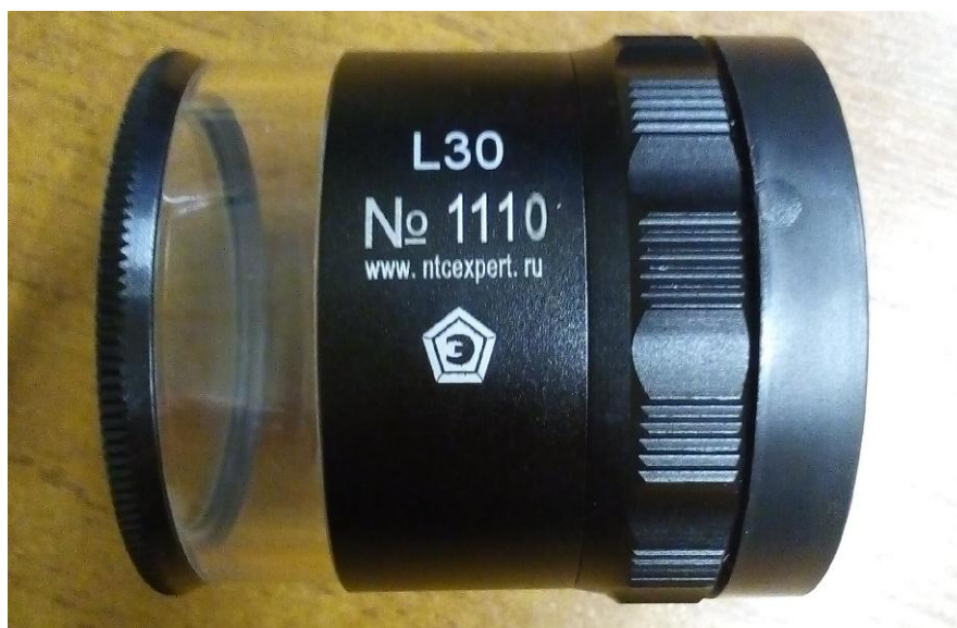
Рисунок 1 - Общий вид лупы измерительной ЛИ-3-10 × с подсветкой (L 30)
