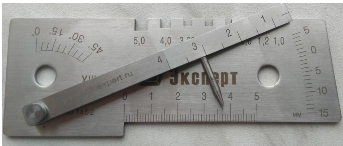
Рисунок 1 - Общий вид шаблона сварщика универсального УШС-3
